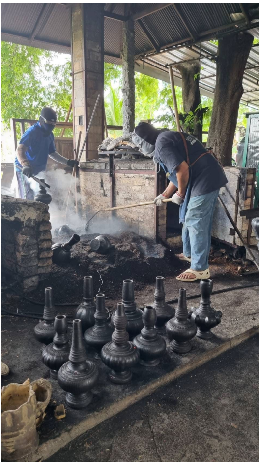
▲ ภาพที่ 89 เาดินเผาในขณะที่ยังร้อนออกจากเตา แล้วนำมาคลุกกับขี้เลื่อยเพื่อบรมดำ ที่มา: เมธิ เมธาสิทธิ สุขสำราญ
