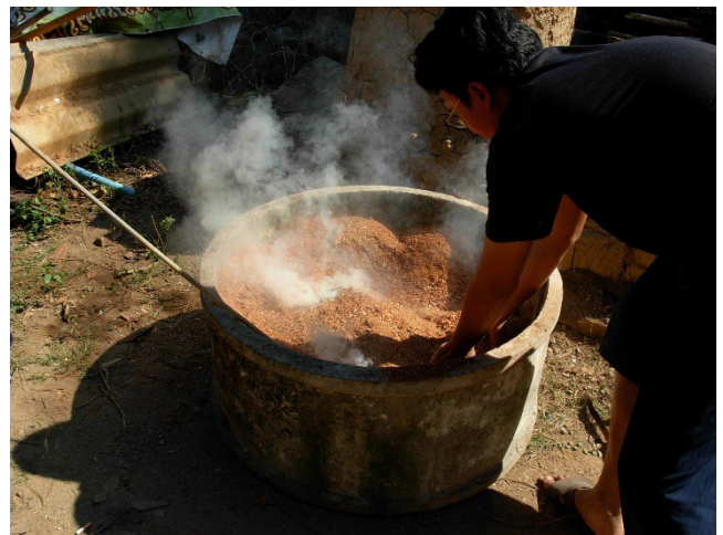
▲ ภาพที่ 89 เาดินเผาในขณะที่ยังร้อนออกจากเตา แล้วนำมาคลุกกับขี้เลื่อยเพื่อบรมดำ ที่มา: เมธิ เมธาสิทธิ สุขสำราญ
