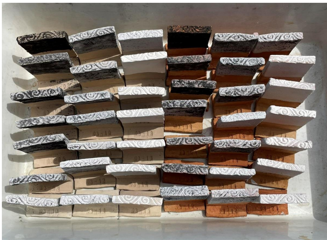
ภาพที่ 93-94 การชุบน้ำเคลือบบนแผ่นทดลองเคลือบก่อนนำไปเผาครั้งที่ 2
